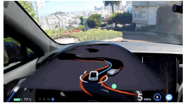
图 7: FSD 在无人工干预下自动行驶通过 S 弯
